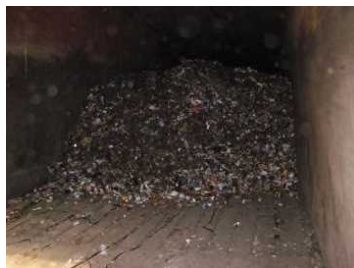
Die Feinfraktion wird biologisch behandelt (Intensivrotte)
